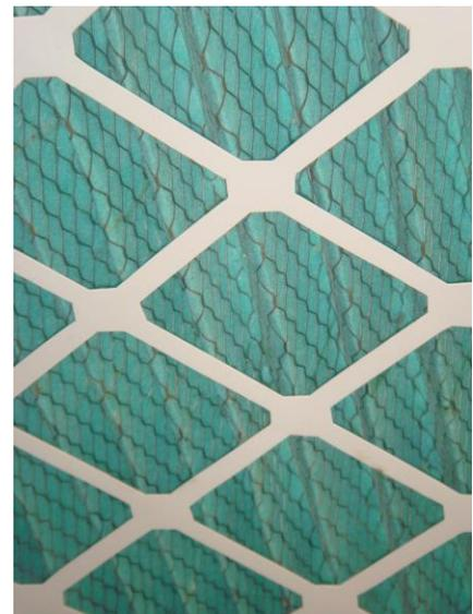
La forma en “V” de los pliegues, el movimiento de aire a través del medio filtrante y la inercia de las partículas de mayor tamaño y peso, ocasiona que estas sean llevadas al fondo de los pliegues, donde son retenidas, las partículas mas finas siguen la trayectoria del aire y son retenidas en las paredes de los pliegues.
