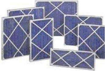
**FILPLEAT:** 25 – 30% ASHRAE, MERV 7 y 90 – 92% en arrestancia. Construcción rígida con gran área filtrante, construido con medio súper esponjoso que brinda altos flujos y bajas caídas de presión (su área libre es del 96%). exclusivo plisado radial (en vez de tipo "v") que ofrece hasta 300% mas eficiencia. Marco de cartón sanitario resistente a la humedad. 1", 2" y 4" de profundidad nominal. Alta capacidad de sólidos, menor caída de presión y excepcional vida útil. Filtro muy económico.
