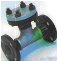
**"T":** Para flujo intermitente. Se fabrican para flujo lineal o recto o para flujo en ángulo de 90°. Construidos en forja de acero al carbón, aceros inoxidable o aceros especiales. Diseño simple adaptable a cualquier tipo de conexión (brida o soldable). Mínima caída de presión. Canasta de lámina perforada con malla (opcional). Tamaños para tuberías desde 2" hasta 24" (mayores sobre pedido). Construidos de acuerdo a Código ASME.
