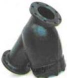
**"Y":** Para retener baja cantidad de sólidos en aire o vapor. Construidos en forja o fundición de acero al carbón, aceros inoxidable o aceros especiales. Diseño simple adaptable a cualquier tipo de conexión. Canasta de lámina perforada con malla (opcional). Tamaños desde 2" hasta 10". Presiones de acuerdo a la aplicación.
