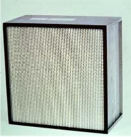
**HEPAFIL:** Filtro rígido de alta eficiencia del tipo de "súper intercepción", con medio filtrante plisado de microfibras de vidrio wet laid y separadores plisados de aluminio, marco metálico de lámina galvanizada (aluminio, acero inoxidable y madera sobre pedido) y sello hermético por empaque (B) o gel (G). Posee alta capacidad de retención y bajas caídas de presión. Alta vida en servicio. Probados individualmente y con certificado (tipos HE y HEP).
