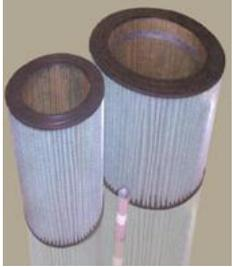
**DOLLFILTER:** Cartucho de plisado radial construido con medios filtrantes de fibras sintéticas específicos para gas (natural, LPG, etc..), núcleos y envolventes de acero al carbón tropicalizado y tapas de plastisol. Flujo directo. Muy bajas caídas de presión. Se ofrecen dos tipos de medios filtrantes:
