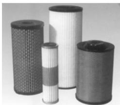
**CERAMFIL:** Cerámica porosa fusionada sin aglutinantes ni adhesivos. Alta resistencia a químicos, presión y temperatura. Reutilizable. Retenciones de 0.2, 0.5, 1, 5, 10, 20, 25, 50, 100, 150 y 200 micras. Todos tamaños y tipos. También se usan como borboteadores (difusión de gas en líquidos).
