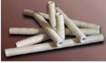
**DEVANFIL:** Tipo encordado, elaborado con fibras de polipropileno, viscosa rayón, algodón, fibra de vidrio, etc. con núcleos metálicos o plásticos. Retenciones de 0.5 , 1, 3, 5, 10, 25, 50, 75, 100 Y 125 micras nominales. 2.5" diámetro exterior x 1" interior. Alturas de 10", 20", 27", 30" y 40". Cubre núcleo opcional. Cartucho muy económico.
